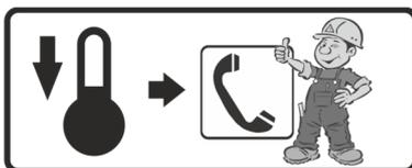
Löst der Sicherheits-Temperatur-begrenzer aus, liegt ein Fehler vor. In diesem Fall muss ein Fachmann die Anlage überprüfen.
